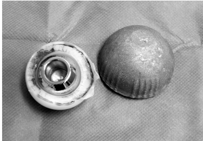
Ryc. 4. Usunięta panewka Avantage z wygładzoną zewnętrzną powierzchnią oraz interferencyjny wkład z widocznym mechanicznym uszkodzeniem polietylenu
